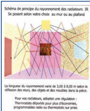
Le radiateur émet des rayons infrarouges à la manière du soleil sur les objets et les personnes. Ceux-ci deviennent à leur tour émetteurs et libèrent ainsi graduellement de la chaleur. Les radiateurs Black Sun Heating transmettent 80% de leur énergie sous forme de rayonnement infrarouge « lointain ou long » et 20% sous forme de convection.
